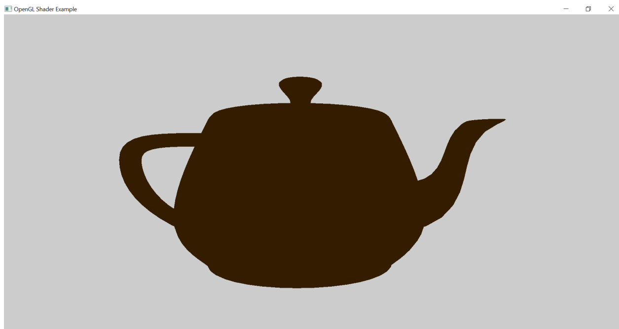
Figura 4 –Rasterizare cu iluminare ambientală
