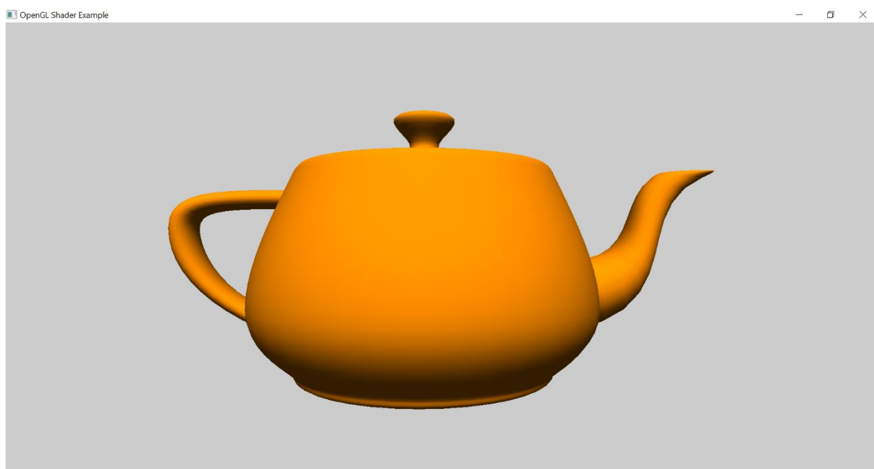
Figura 5 – Rasterizare cu iluminare ambientală și difuză
