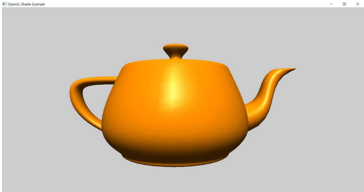
Figura 6 – Rasterizare cu iluminare ambientală, difuză și speculară
