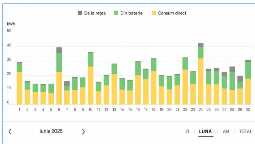
Fig. 69. – Representarea zilnică grad acoperire consum, direct și din baterii pentru un mic prosumator industrial – luna de vară . Sursa: platformă invertor, anul 2025, putere instalată 3 kWp, cu BESS
