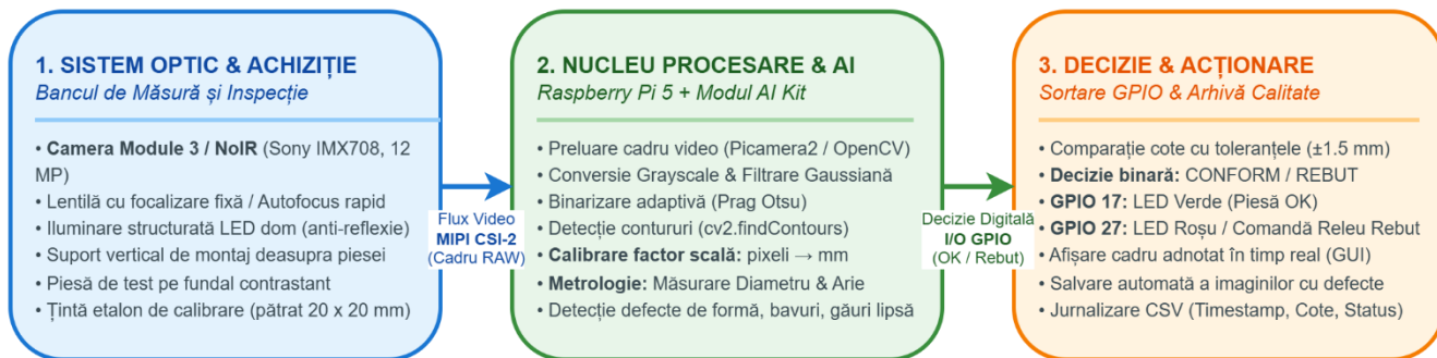
Figura 6.1 Lanțul de procesare a imaginilor și arhitectura stației AOI cu Raspberry Pi 5
